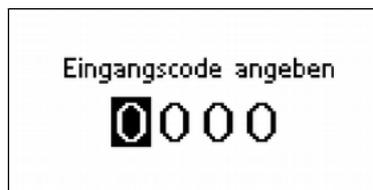
Um die Service-Funktionen des Steuergerätes ST-480zPID zu nutzen, muss der vierstellige Code eingegeben werden. Dieser Code ist nur dem Hersteller des Kessels und der Firma Tech bekannt.
