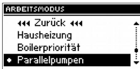
In diesem Modus arbeiten die beiden Pumpen parallel über die Schwelle für das Einschalten der Pumpen (werkseitig ist die Schwelle auf 40°C eingestellt).
