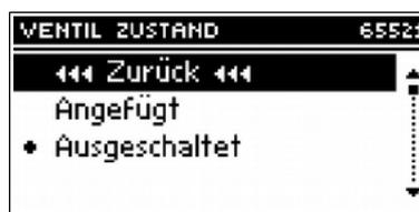
Diese Funktion ermöglicht die Aktivität des Ventils zeitweilig auszuschalten, ohne es vollständig zu entfernen. Nach nochmaligem Einschalten ist eine Anmeldung nicht erforderlich.
