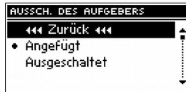
Diese Option ermöglicht es, den automatischen Betrieb des Aufgebers aktivieren oder deaktivieren. Der Aufgeber kann deaktiviert werden, um manuell den Brennstoff zuzuführen oder um den Kessel zu löschen.
