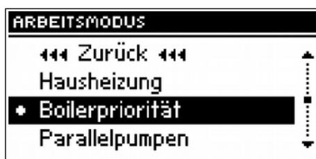
In diesem Modus wird als erste die Pumpe des Boilers (Warmwasser) eingeschaltet, bis die eingestellte Temperatur erreicht wird. Nach Erreichen der eingestellten Temperatur des Warmwasserboilers wird die Pumpe ausgeschaltet und die ZH-Pumpe eingeschaltet. Die ZH-Pumpe arbeitet so lange, bis die Warmwassertemperatur unter den Sollwert sinkt. Dann wird die ZH-Pumpe ausgeschaltet und die Warmwasserpumpe eingeschaltet.
