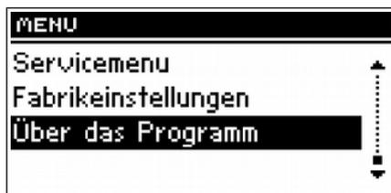
In dieser Funktion kann der Benutzer überprüfen, welche Version des Programms das Steuergerät hat.
