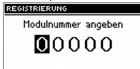
In diese Funktion trägt der Installateur die Seriennummer des Steuermoduls mit dem Antrieb des Dreiwegeventils ein (ST-61, dies ist eine fünfstellige Nummer, die sich auf dem Gehäuse dieses Moduls befindet). Ohne diese Nummer ist diese Funktion nicht aktiv.
