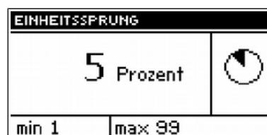
In dieser Funktion wird der Einheitssprung bei der Ventilöffnung in Prozent, d.h. wie groß in Prozent der minimale Sprung beim Öffnen oder Schließen des Ventils ist, eingestellt.
