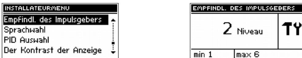
Mit dieser Einstellung kann die Empfindlichkeit des Drehknopfes des Impulsgebers im Bereich von 1 bis 3 (wobei 1 die höchste Empfindlichkeit ist) geändert werden.
