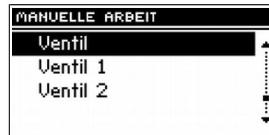
Das Drücken des Impulsgebers startet den Motor des gewählten Geräts. Dieses Gerät läuft, bis der Impulsgeber erneut gedrückt wird.
