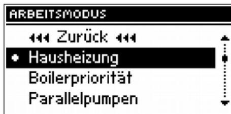
Mit der Auswahl dieser Option geht der Regler in den Modus, wo nur das Haus geheizt wird, über. Die ZH-Pumpe beginnt über der Schwelle für das Einschalten der Pumpen arbeiten (werkseitig ist die Schwelle auf 40° C eingestellt). Unterhalb dieser Temperatur schaltet sich die Pumpe aus.
