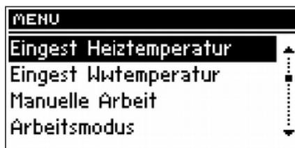
ssels einzustellen. Der Benutzer kann die Kesseltemperatur im Bereich von 45°C bis 80°C ändern. Die eingestellte Heiztemperatur kann auch direkt vom Hauptbildschirm des Steuergerätes durch Drehen des Drehknopfes des Impulsgebers geändert werden.
