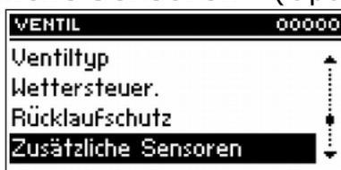
Wenn im Einsatz zwei Mischventile sind, nach der Wahl dieser Funktion kann der Benutzer Sensoren wählen, von den Daten über die Temperatur für das Ventil (für Sensoren der externe- und Rücklauftemperatur) entnommen werden. Temperaturen können von Sensoren des eingestellten Ventils (eigene) oder entsprechend den Sensoren des Ventils2 (vom Modul 2) entnommen werden.
