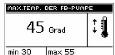
Diese Funktion wird verwendet, um die Fußbodenheizung zu steuern. Der Benutzer kann die Temperatur der Fußbodenheizung im Bereich 30°C – 55°C einstellen. Nach der Aktivierung (Einschalten) der Fußbodenpumpe ist die minimale Einschalttemperatur (Schwelle) der Pumpe (am Kessel gemessen) und die maximale
