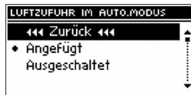
Mit dieser Funktion kann man die automatische Betätigung des Ventilators aus- oder einschalten. Die Zuluft kann man ausschalten, um den natürlichen Schornsteinzug manuell zu steuern.
