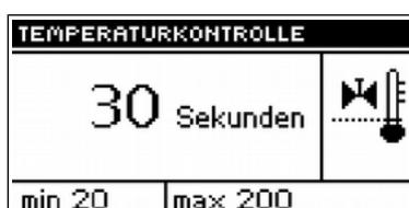
Dieser Parameter bestimmt die Abtastfrequenz (Kontrolle) der Temperatur des
