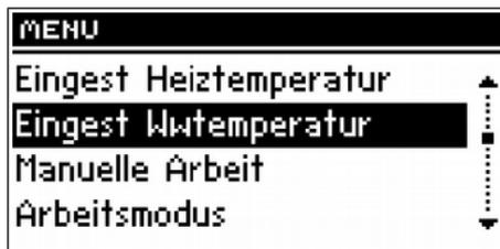
Diese Option wird verwendet, um die gewünschte Temperatur des Warmwassers einzustellen. Der Benutzer kann die Kesseltemperatur im Bereich von 45°C bis 80°C ändern.
