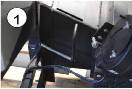
Fot. 1. Feder der Zuführklappe
