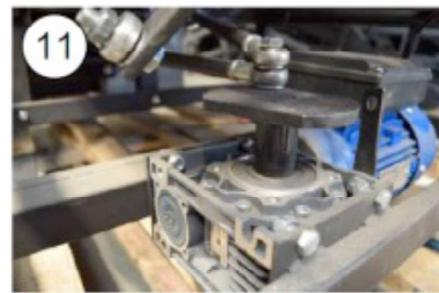
Fot. 11. Getriebemotor
